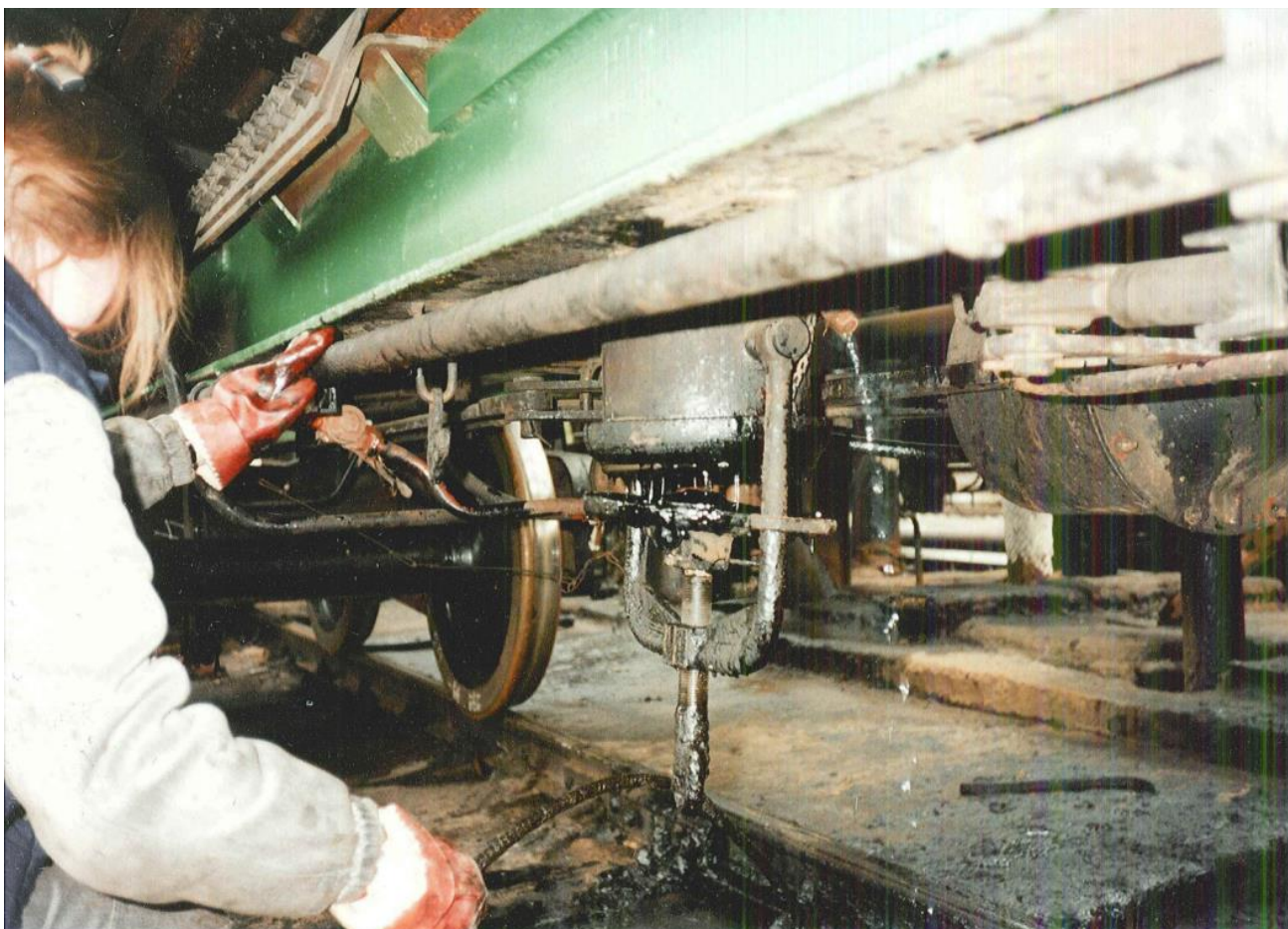
Fotod 10. Autotsisternide laadimine ja raudteesisternide alt tühjendamine.
